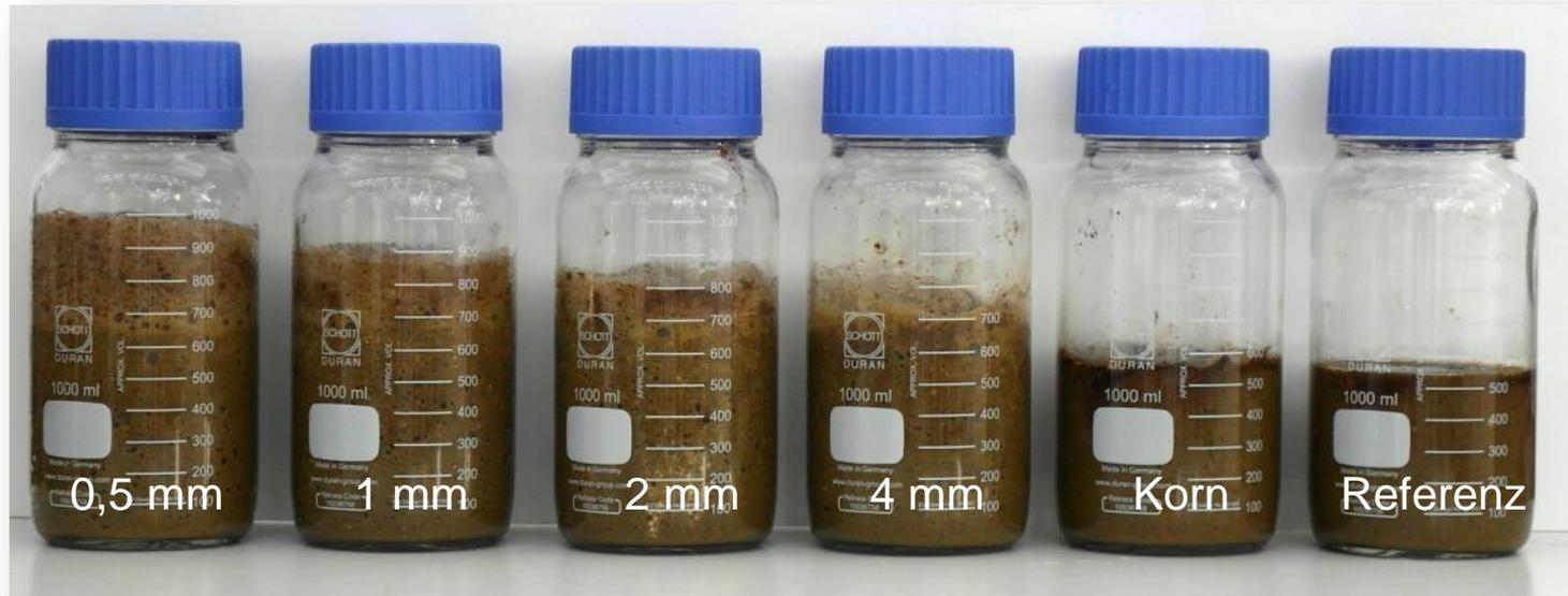
Gärmaterial aus einer NawaRo-Anlage mit Triticaleschrot (0,5 mm, 1 mm, 2 mm und 4 mm) und -korn
